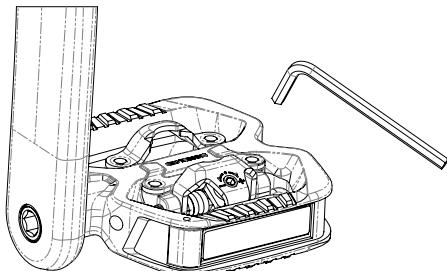
La regolazione non può essere effettuata quando la tacchetta è inserita nel pedale. Durante l'avvitamento, l'aumento della forza richiesta darà l'indicazione della regolazione massima. Una volta raggiunto questo livello di regolazione, smetti di avvitare per evitare di danneggiare il pedale.
