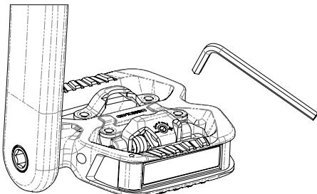
Die Einstellung kann nicht vorgenommen werden, wenn die Pedalplatte im Pedal eingerastet ist. Beim Verschrauben zeigt ein Anstieg der erforderlichen Kraftanwendung an, dass die maximale Einstellung erreicht wurde. Sobald dieser Punkt erreicht ist, sollten Sie aufhören zu schrauben, um eine Beschädigung des Pedals zu vermeiden.
