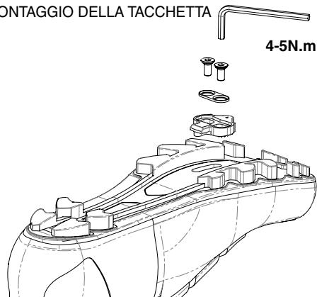
abbastanza strette sotto le scarpe. Fissate la tacchetta sotto la suola della scarpe solo con le viti fornite con le tacchette. Controlla regolarmente che le tacchette non si siano spostate sotto le scarpe, specialmente se hanno suole in fibra di carbonio.
