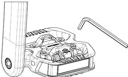
Le réglage ne peut être effectué lorsque la cale est enclenchée dans la pédale. Lors du vissage, un durcissement de l'effort nécessaire donnera l'indication du réglage maximal. Une fois ce durcissement atteint, arrêtez de visser pour ne pas risquer d'endommager la pédale.
