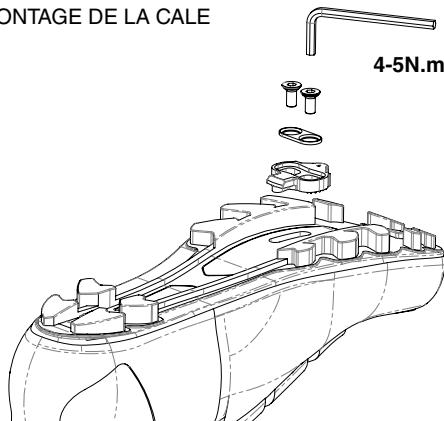
Assurez-vous que la semelle soit propre au niveau de l'interface avec la cale, et au besoin nettoyez-la à l'aide d'un chiffon humide.
