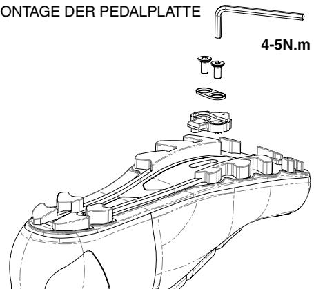
angebracht sind, bevor Sie die Schuhe einrasten. Befestigen Sie die Pedalplatte unter der Schuhsohle nur mit den mitgelieferten Schrauben. Überprüfen Sie regelmäßig, dass die Pedalplatten unter dem Schuh nicht verrutscht sind, insbesondere wenn sie Carbon-Sohlen tragen.
