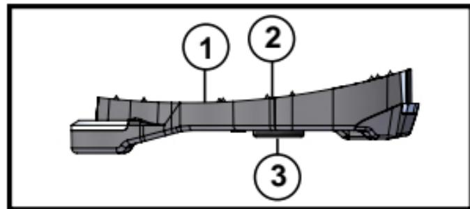
**2: Referencia eje – pedal:** esta referencia corresponde a la posición del eje del pedal cuando la cala está colocada.
