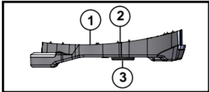
Verificare preventivamente la curvatura della suola delle scarpe presso un rivenditore autorizzato che disponga di uno strumento adatto alla verifica. Consigliamo un raggio di curvatura di 150 mm. Oltre i 170 mm raccomandiamo l'utilizzo di KEO SPACER per suole a curvatura ridotta.
