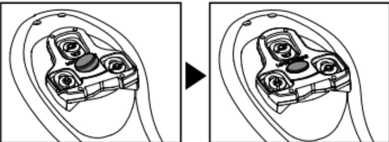
Faites vos réglage de cale (voir § précédent) sans le PAD (mais ne faites pas une sortie complète sans le PAD). Une fois le réglage trouvé, vissez la mémoire et insérez le PAD par l'extérieur (Voir schéma ci-contre).
