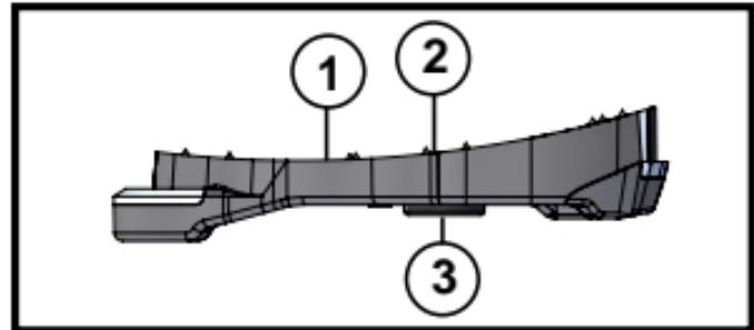
Vérifiez la courbure de la semelle de vos chaussures au préalable chez un détaillant agréé qui dispose d'un outil permettant la vérification. Nous préconisons un rayon de courbure de 150mm. Au-delà de 170mm nous recommandons l'utilisation des KEO SPACER pour semelles à faible courbure.
