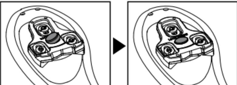
Effettuare la regolazione della tacchetta (vedere § precedente) senza PAD (non usare la bici senza il PAD). Quando è stata effettuata la regolazione, avvitare la memoria e inserire il PAD dall'esterno (vedere schema a fianco).
