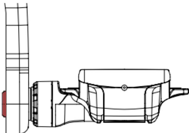
**Achtung, bei Benutzung des Positionsmarkierers muss der PAD von außen von der Schuhplatte, nachdem diese an der Sohle befestigt worden ist, positioniert werden. Dies ist aufgrund seiner Form und seines Materials einfach möglich (siehe nachfolgender Abschnitt).**
