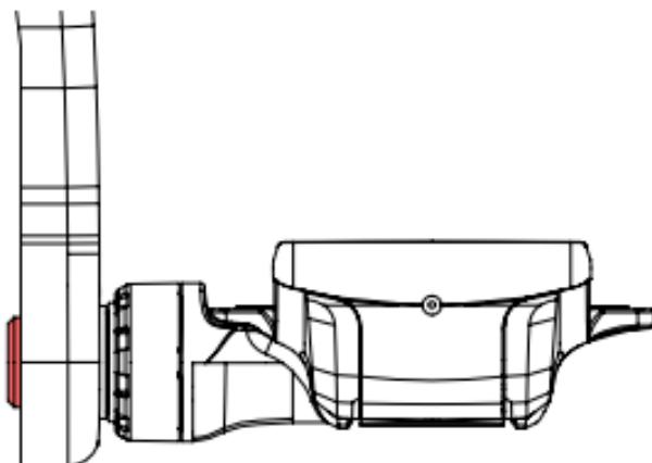
**4 : PAD:** Tampón de compensación del juego entre la cala y el pedal. Es indispensable para el buen funcionamiento.
