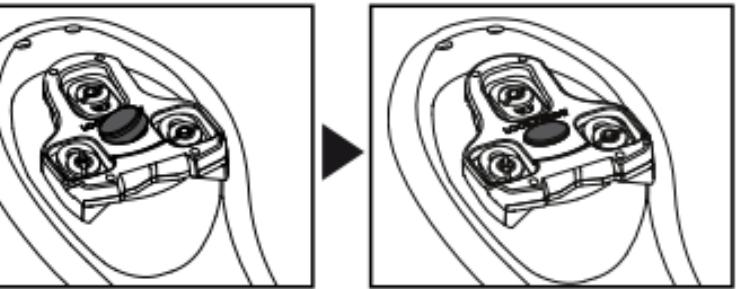
Haga los reglajes de la cala (ver § anterior) sin el PAD (pero no haga una salida completa sin el PAD). Una vez encontrado el reglaje, atornille la memoria e inserte el PAD por el exterior (Ver esquema al lado).
