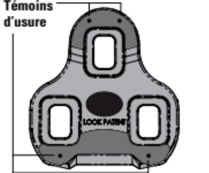
**Attention : Il devient dangereux d'utiliser la cale lorsque les patins sont assez usés pour laisser apparaître l'un des témoins d'usure. (cf. schéma ci-contre)**
